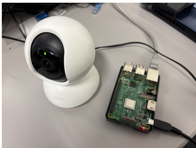
図 2: 実装に用いたエッジデバイスとネットワークカメラ
