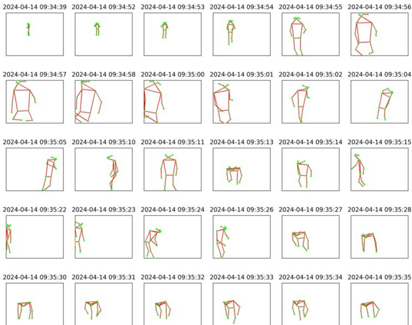
図 3 本実験で時系列画像と姿勢検出モデルを統合した連続的な出力関節の可視化結果例。
