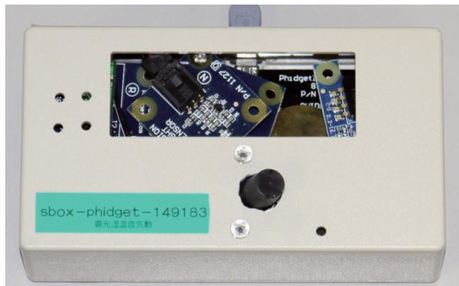
図 4 作成したセンサボックス
