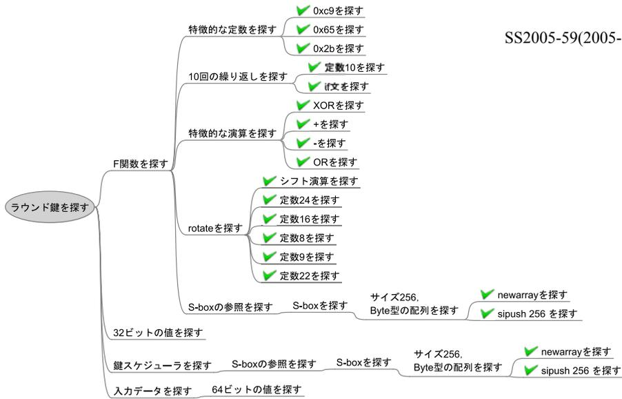
図 5 C2 暗号プログラムに対する攻撃モデルの一例
