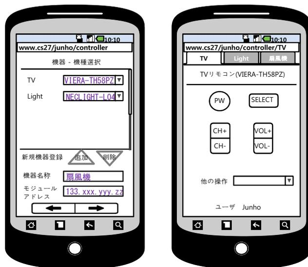
図 4 操作アプリケーションのイメージ図：(左)機種選択画面、(右)操作画面
