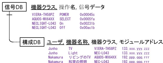
図 3 家電リモコンサービスのデータベース設計
